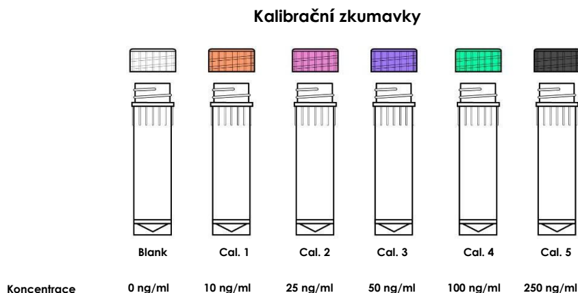
Obrázek 1. Připravené kalibrátory pro vypracování kalibrační křivky (5 bodů a čistá)
